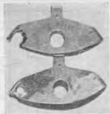
Рис. 5. Оплавленные контакты предварительного переключателя ответвлений.
