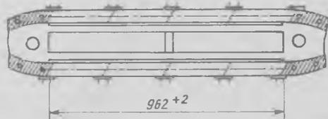
Рис. 18. Расстояние между боковыми стальными пластинами
