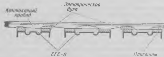
Рис. 12. Образование волнообразного износа
