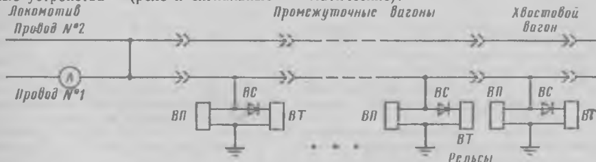
Рис. 1. Принципиальная схема электрического дублированного питания ЭПТ
