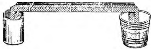
Рис. 9. Прибор для изучения отношения клещей к разным температурам
